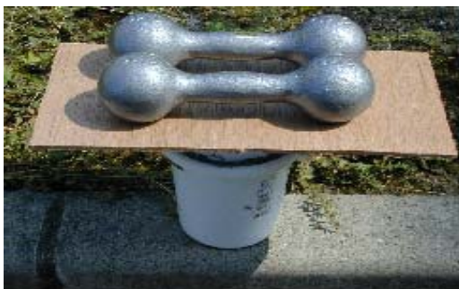
Fig.4 圧縮成型したものの乾燥様子
