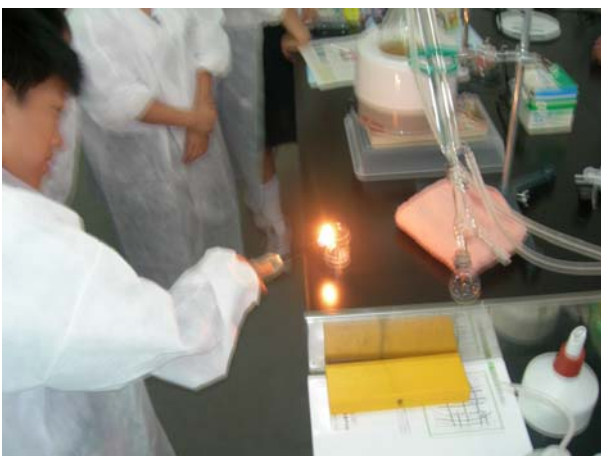
図6 蒸留で回収したエタノールへの点火実験
