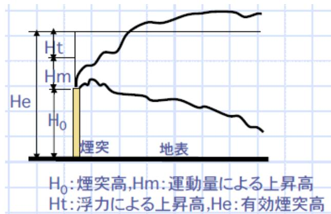
図5 有効煙突高度の定義
