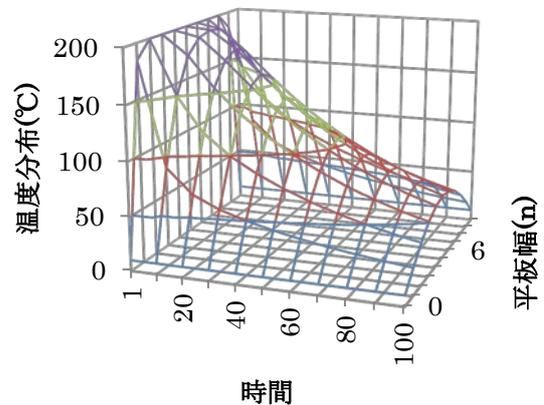
図4 等高線図による温度分布図
