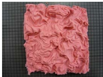
図7 アルギン酸印象剤への皺の転写結果
