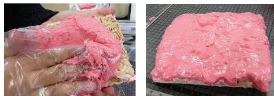
図2 粘土板からのアルギン酸塩への皺構造の転写工程
