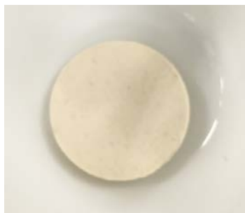
図2 錠剤化したかんぴょう粉末試料 (直径 15mm, 厚さ 2mm)
