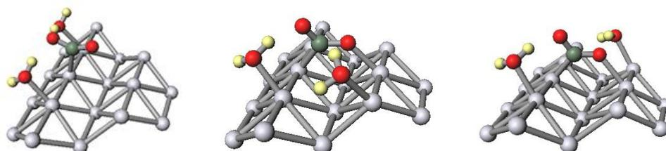
これらのモデルを計算し、 $\text{CO}_2$  の吸着構造の検討を行う。それにより得られた安定構造を出発構造とし、水素を駆動力とした  $\text{CO}_2$  還元の経路を探索していく。
