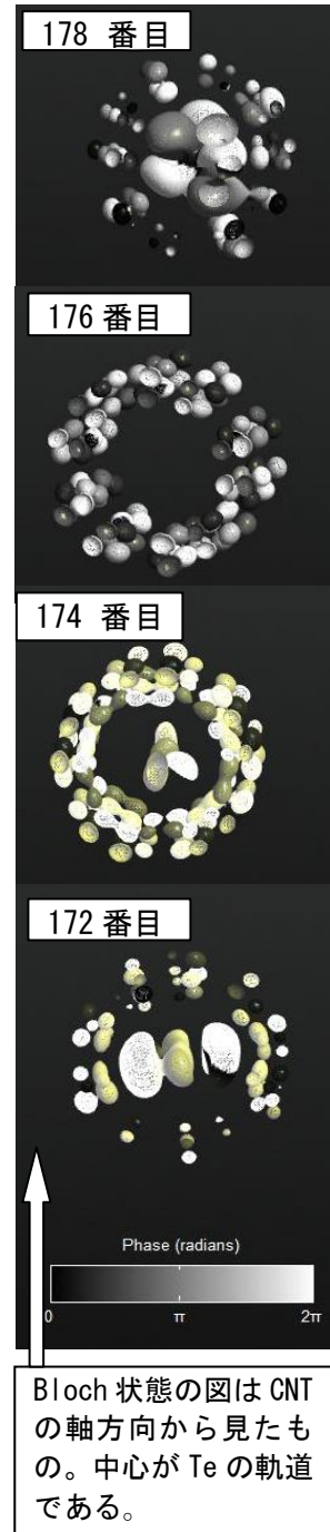
図 3 Te を CNT (5, 5) へ挿入した系のバンド構造。左が全構造で、中央はフェルミ面付近を拡大したもの。点線はフェルミ準位。右はフェルミ面付近のバンドのブロッホ状態を描いたもの上から 178, 176, 174, 172 番目のバンドを描いている。176 番目のバンドが純 CNT 的であるが、他は、Te と CNT の状態はかなり混合している。
